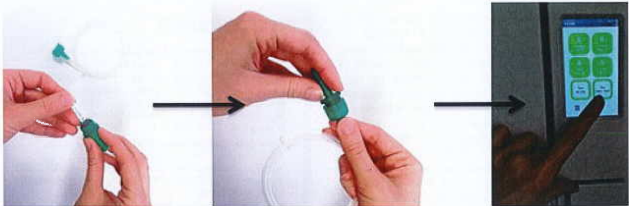
Fig. 2 : mise en œuvre du test Helix®, lancement du programme adapté dans le stérilisateur.
