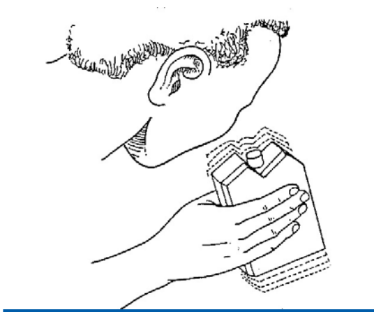
Figure 30 : Vérification des accumulateurs de froid
