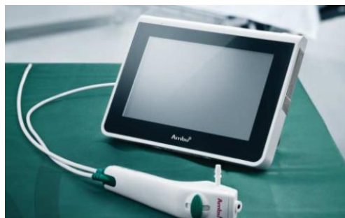
Figure 24: Bronchoscope à usage unique Ambu® aScope™ 3 Regular
