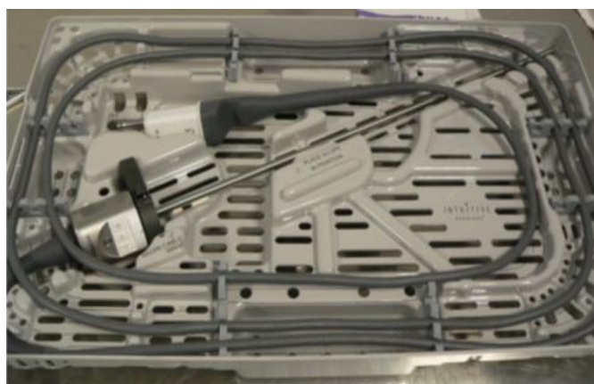
Figure 28: Optique du robot Da Vinci Xi® dans sa boîte thermoformée
