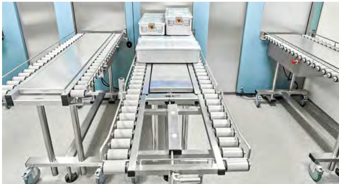
Chariots à hauteur variable en zone de chargement/déchargement
